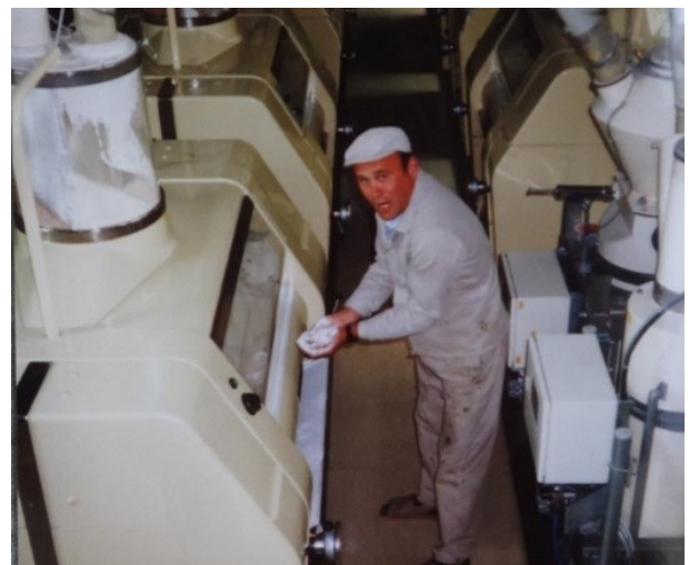
Der Walzenboden im vollautomatisierten Betrieb: Willi Dick kontrolliert die gleichmäßige Verteilung des Mahlguts auf der Walze
